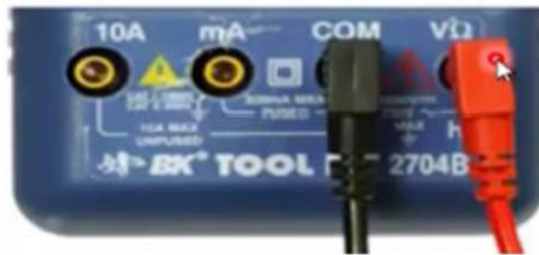
شكل رقم ٣٧: أطراف توصيل لفحص التوصيلية
