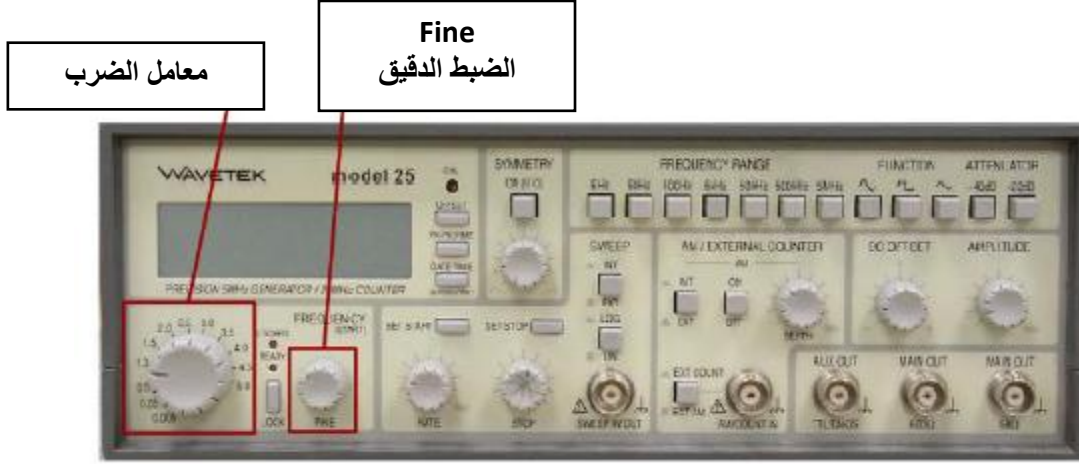
شكل رقم ٤٥: مفاتيح ضبط القيمة المطلوبة للتردد
